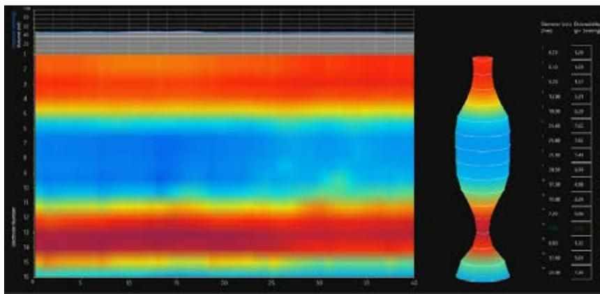
**Figura 2.** EndoFLIP institucional realizado con catéter EF-322 de 16 cm. A la derecha, módulo FLIP 1.0 con representación 3D del esófago y sus diámetros. A la izquierda, FLIP 2.0 con imagen topográfica del esófago.
