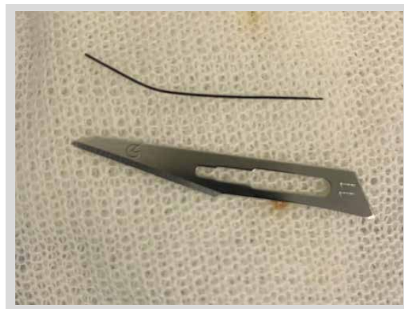
Figura 3. Fragmento de alambre metálico, compatible con un filamento de cepillo de limpieza, se compara su tamaño con una hoja de bisturí.
